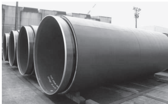
写真2 水道用推進鋼管
