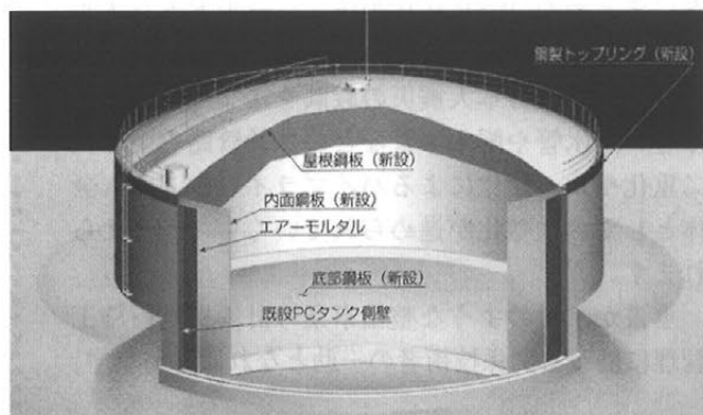
図-1 タンク更新工法Ⅰ(内接型)
