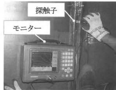
図-2 超音波探傷試験状況
