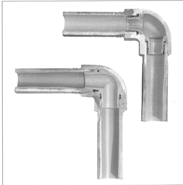
管内面 使用後の状況（内面腐食はありません）
