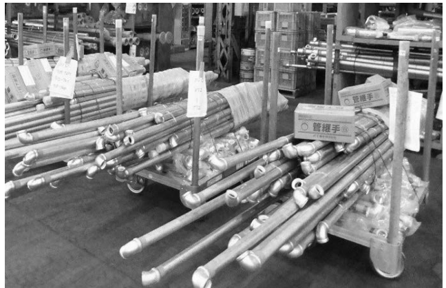
写真-2 現場ごとにまとめられたパーツ部材
