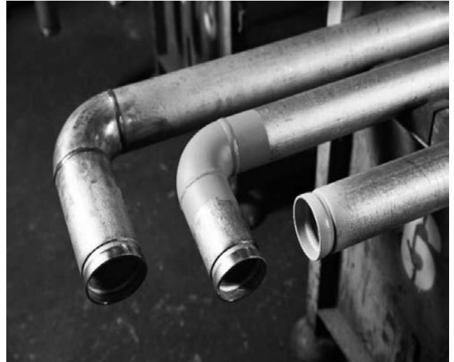
写真-1 加工・組み立てられた配管部材
