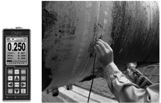
写真－2 超音波板厚計（例）
